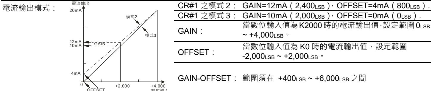
上列表示電壓輸出模式與電流輸出模式之 D/A 轉換特性曲線，使用者可依據實際應用需要來調整轉換特性曲線，調整時以改變 OFFSET 值 (CR#14 ~ CR#15) 及 GAIN 值 (CR#18 ~ CR#19) 來進行。
